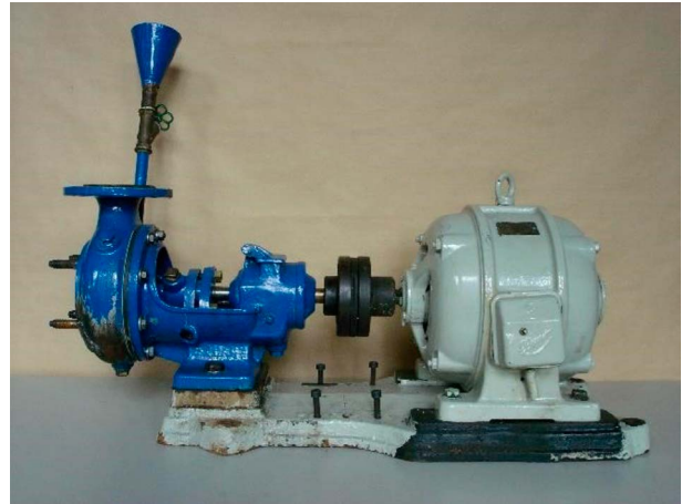
Fundamentpumpe ohne Abdeckung
